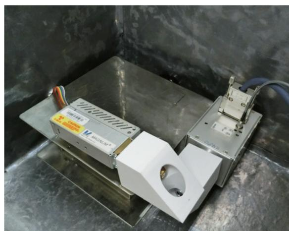
図 4. 図 3 のホルダに検出器・X 線管を配置した偏光度測定装置
