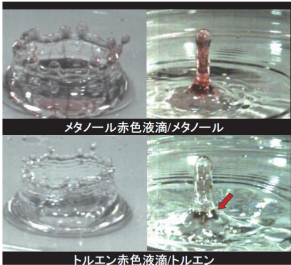
図 5. メタノール(上)とトルエン(下)着色滴の液面落下
