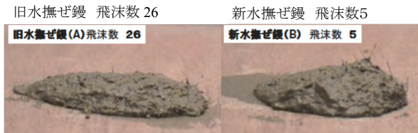
図 20. 鋺から落下し、飛沫を発生した土壁材料の性状
