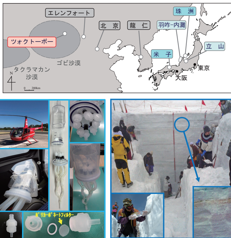
図2. 東アジアを網羅するバイオエアロゾルの観測サイトとヘリコプターと立山積雪を利用したサンプリング手法
