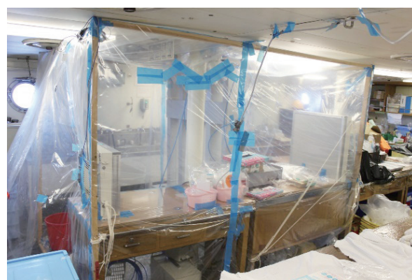
図3. GEOTRACES 航海中白鳳丸船内に築いたクリーンサンプリングスペース「bubble」。
