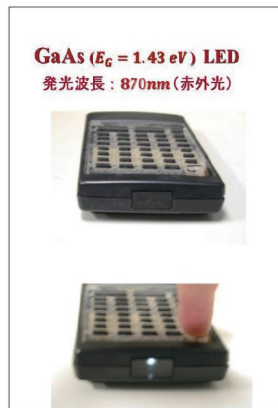
第4図 デジカメで撮ったGaAs LEDの発光
