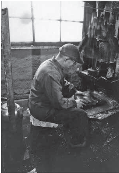
図9. 箔打ち機による銀箔作り. 打撃音が響く. 1969年2月撮影.
