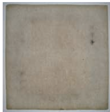
図2. 雁皮紙の箔打ち紙(188mm×185mm)。この上に金箔の元を置き、数百枚以上重ねられる。書かれている文字により表裏を揃え、縦横の大きさの違いにより90度ずつ、ずらしていく。打撃力の偏りを避けるためである。
