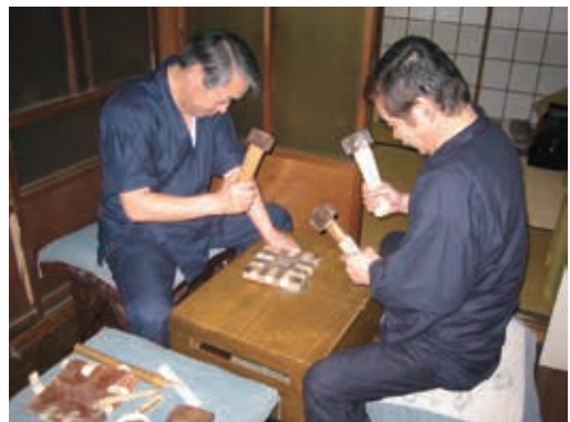
図 8. 100年ぶりの手打ちによる金箔打の試み. 中央の石の上で打たれる. 2006年7月撮影.
