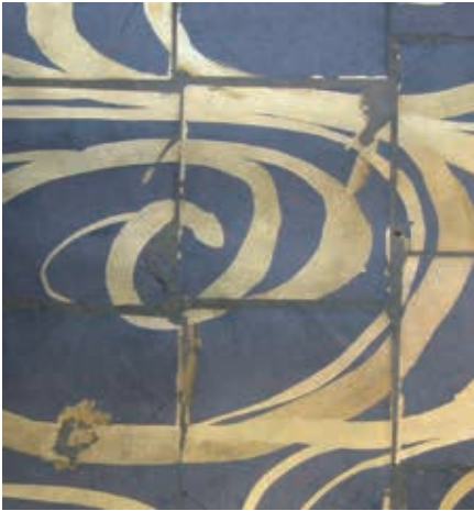
図 37. 硫黄と松脂で燻すと、光琳波以外、硫化が進む（2006年9月）。
