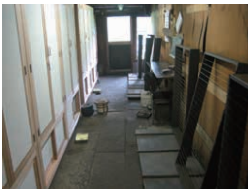
図 33. 燻べ屋さん。左側の小部屋に銀箔を並べ、硫黄と松脂を混ぜたものを皿にのせ燻す。
