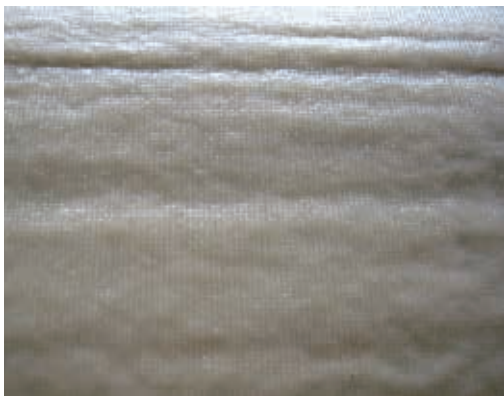
図 5. 漉きあがった雁皮紙. 麻の紗の凹凸が見える.
