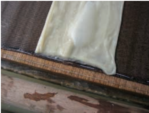
図 4. 竹のスノコの上に麻の紗が張られている. 上は失敗した雁皮紙.
