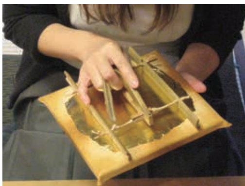
図 13. 大きな打ち上がり金箔から、正方形の金箔を切り出す。
