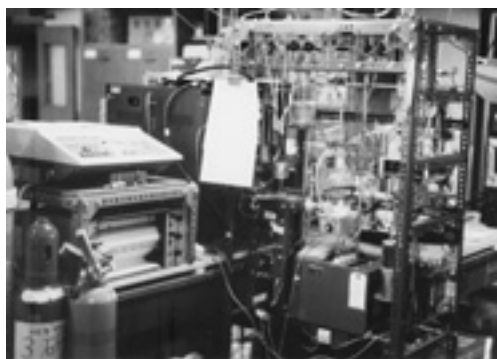
図2 初代白鳳丸の第3研究室に搭載したメタン分析装置。
