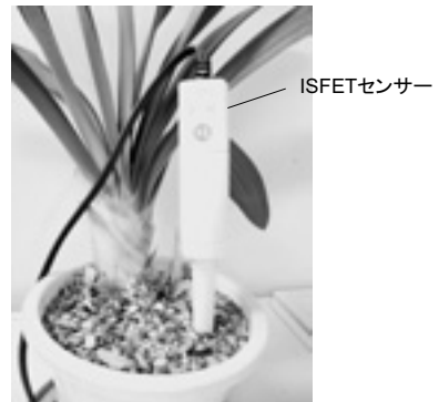
図4： ISFETによる土壌直接測定
