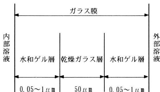
図 4. ガラス電極膜の構造
